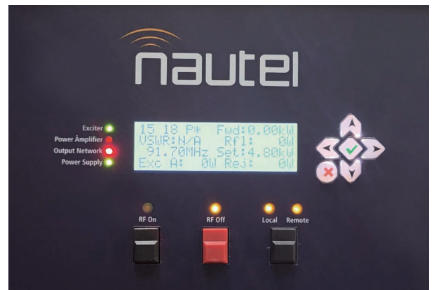
그림 6. 송신기 User Interface
