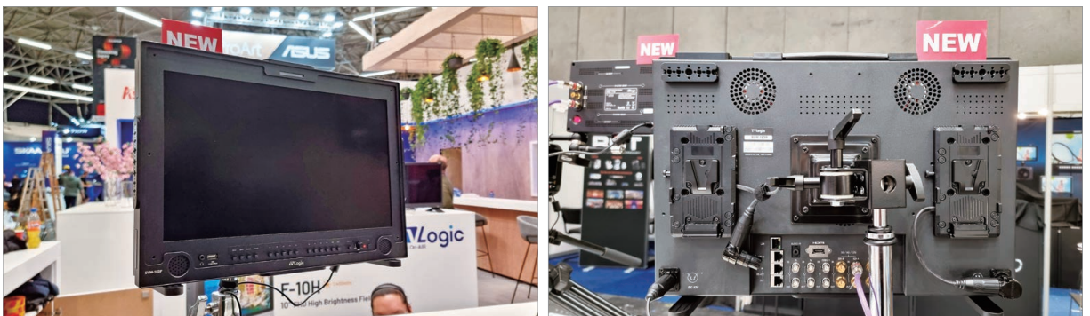
SVM-183P. 동그란 전면 Speaker Holes를 가지고 있으며, 본체에 C-stand Mount Adapter, 2개의 V-Mount Plate가 장착된 채로 전시되었다.
