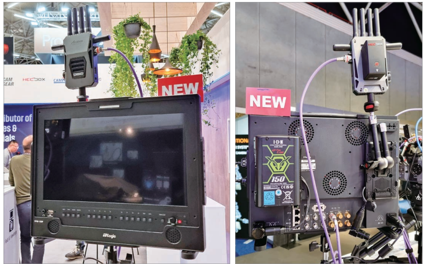
SVM-130P. 앞쪽에 귀여운 2개의 Speaker Holes를 가지고 있으며, 본체에 Accessories 장착이 바로 가능한 3/8", 1/4" Hole들이 마련되어 있다. C-stand Mount Adapter, 2개의 V-Mount Plate, Wireless Transmitter가 장착된 채로 전시되었다.
