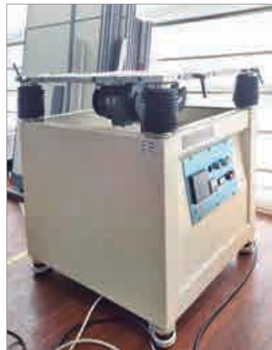
TVLogic의 모든 제품에 대해 진동 Test를 진행하는 장비의 모습
