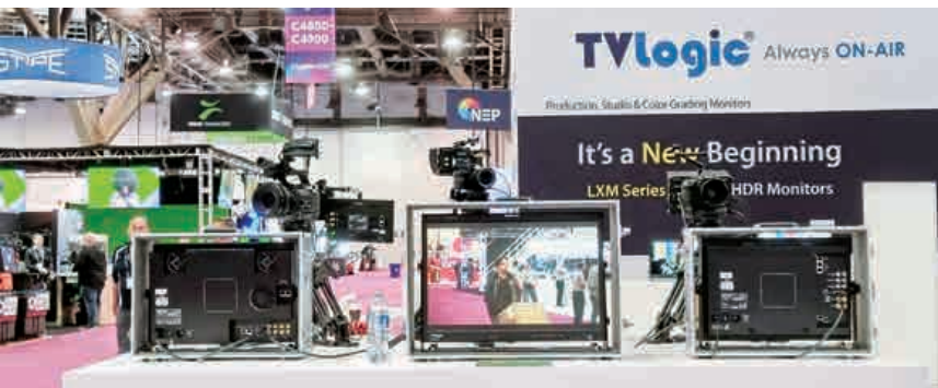
Aluminum Carrying Case에 제품을 장착하여 전시된 모습. Case 바닥 면에 Monitor의 Stand를 고정하는 Bolt가 위치해 있다. Case 앞면면 모두 Open 되는 Type(Dual Door)의 경우 BNC Cable과 전원 연결이 용이해 선호된다.
