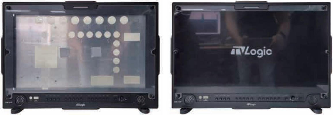
신제품 SVM-130P, 183P의 출시와 함께 TVLogic이 최초로 선보인 LCD Protector의 모습. Acrylic Filter와 함께 동시 장착이 가능하다.
