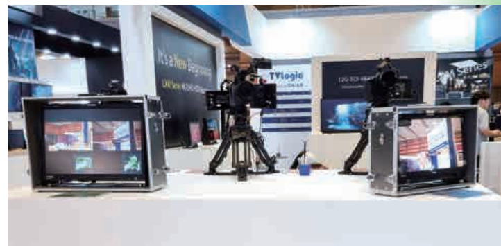
Aluminum Carrying Case에 제품을 장착하여 전시된 모습. Case 바닥 면에 Monitor의 Stand를 고정하는 Bolt가 위치해 있다. Case 앞면면 모두 Open 되는 Type(Dual Door)의 경우 BNC Cable과 전원 연결이 용이해 선호된다.
