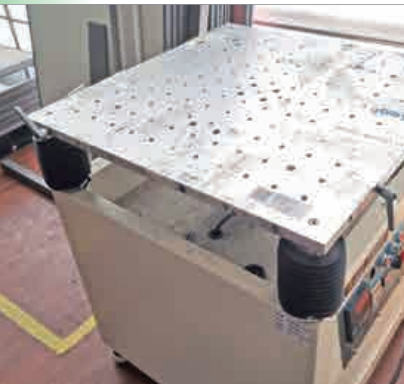
TVLogic의 모든 제품에 대해 진동 Test를 진행하는 장비의 모습
