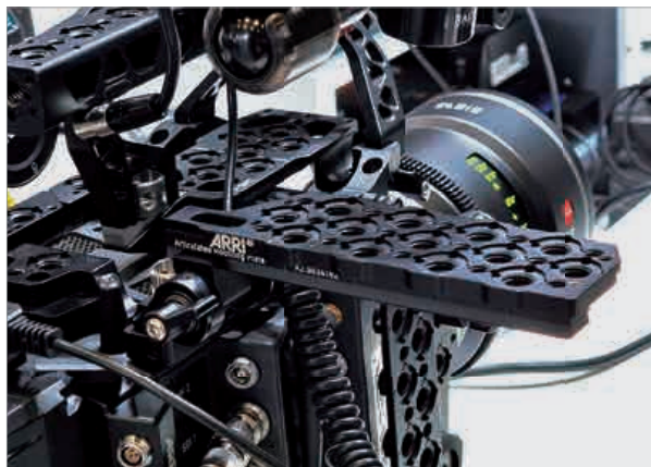
ARRI사의 Mounting Plate가 Camera에 장착된 모습. 여러 개의 Mounting Hole을 가지고 있어 다양한 장비들을 손쉽게 부착할 수 있다.
