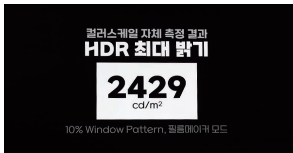
HDR 모드에서의 최대 밝기 측정 결과
