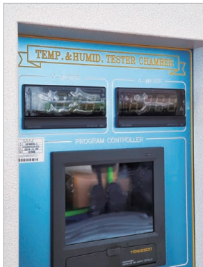
TVLogic의 모든 제품에 대해 온도 및 습도 Test를 진행하는 Chamber의 모습
