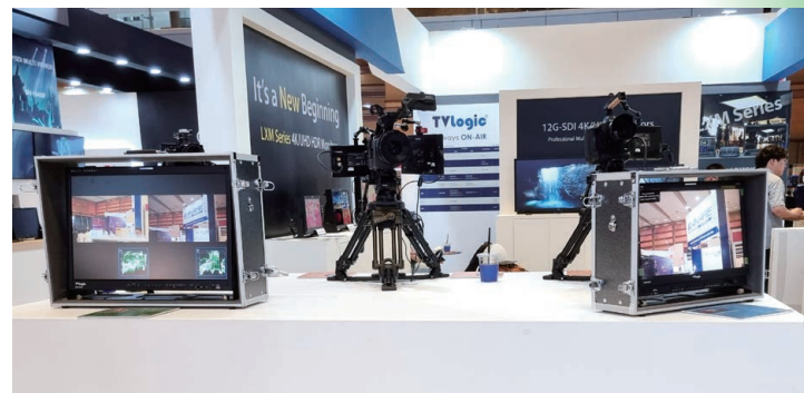
Aluminum Carrying Case에 제품을 장착하여 전시된 모습. Case 바닥 면에 Monitor의 Stand를 고정하는 Bolt가 위치해 있다. Case 앞뒷면 모두 Open 되는 Type(Dual Door)의 경우 BNC Cable과 전원 연결이 용이해 선호된다.
