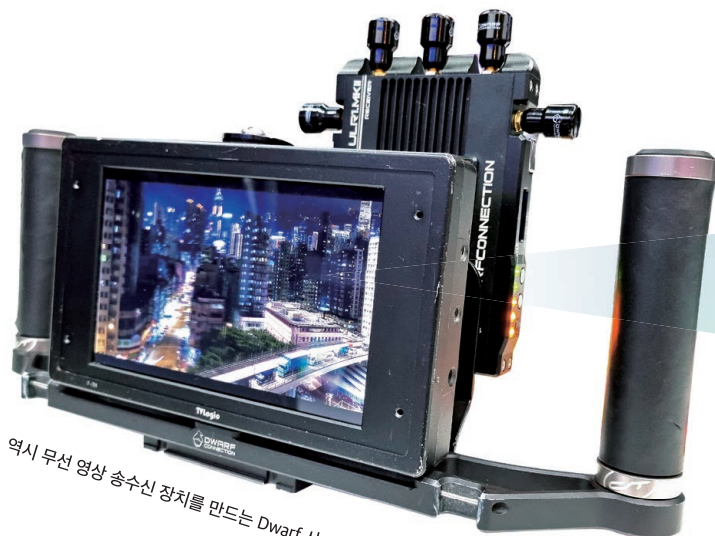
Accsoon 사의 무선 영상 송수신 장비의 모습. 무선 영상 송수신 장치도 자주 사용되는 Accessory다.
