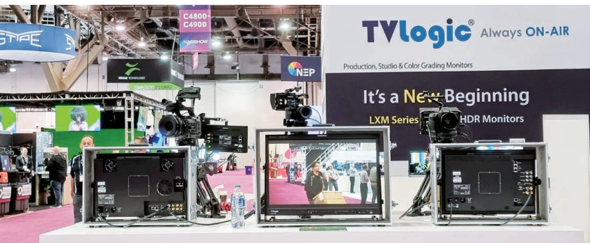
Aluminum Carrying Case에 제품을 장착하여 전시된 모습. Case 바닥 면에 Monitor의 Stand를 고정하는 Bolt가 위치해 있다. Case 앞뒷면 모두 Open 되는 Type(Dual Door)의 경우 BNC Cable과 전원 연결이 용이해 선호된다.
