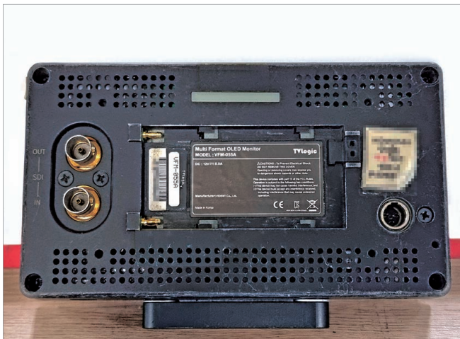
5", 7", 9" 제품 후면에는 NP Battery 또는 V-Mount Battery가 직접 장착될 수 있도록 Battery Mount가 Built-in 되어 있다.
