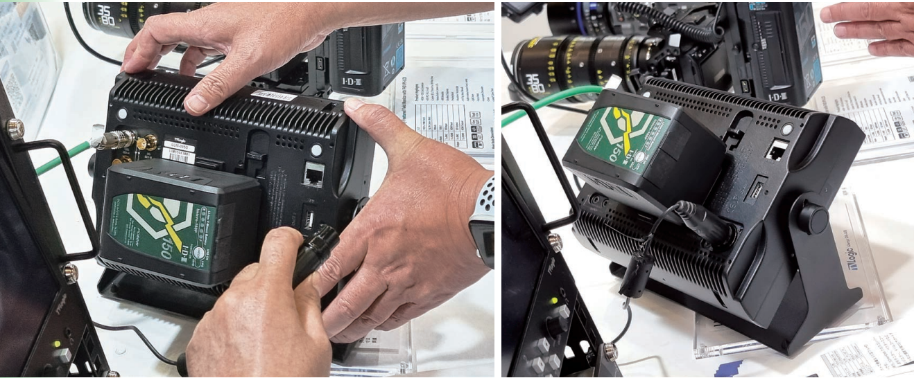
9" Panel을 사용한 LVM-095A, LUM-095G의 제품 후면부에는 V-Mount Battery가 직접 장착될 수 있는 V-Mount가 새겨져 있다. 이것은 10.1" Panel을 사용하는 최신 LVM-096A, LUM-096G도 동일하다.
