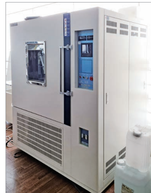
TVLogic의 모든 제품에 대해 온도 및 습도 Test를 진행하는 Chamber의 모습
