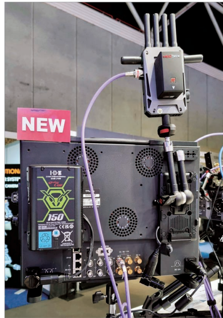
Inter BEE 2024에서 만난 Japan 업체의 C-Stand Mount Adapter의 모습. 전용의 Pigot과 맞물려 고중량의 Monitor도 잘 견디도록 설계되었다.
