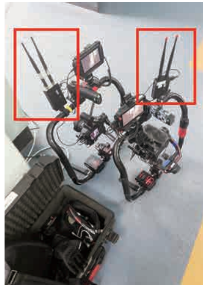
그림 3. 무선 송수신 장비 설치
