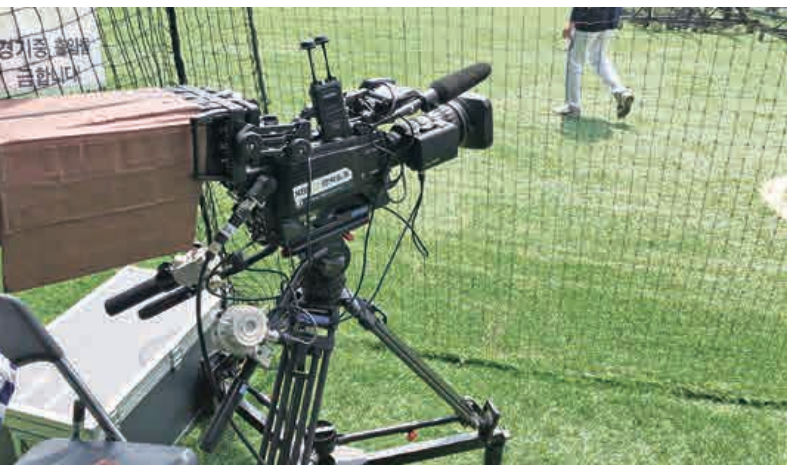
그림 1. 기존 리턴 방식의 스탠다드 카메라 & EFP 카메라 뷰파인더
